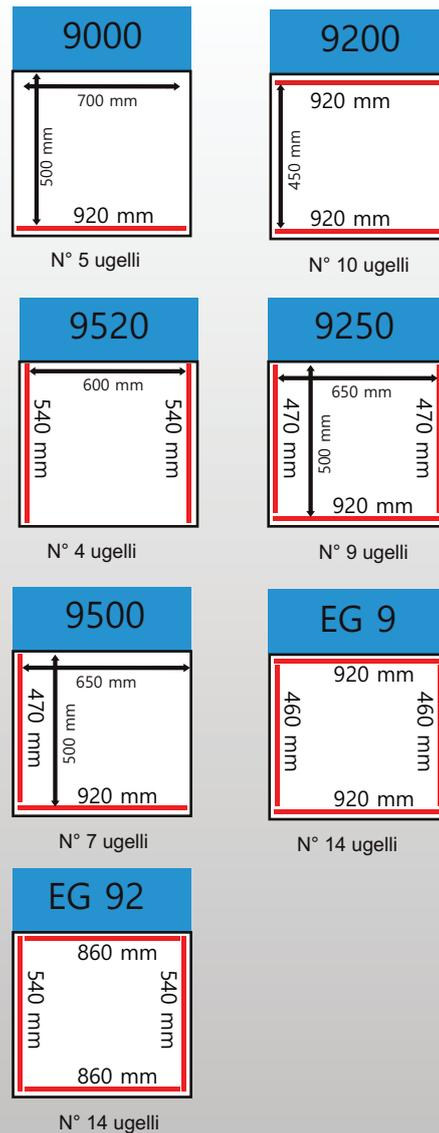
**Barre saldanti:** le barre saldanti nelle sottovuoto carrellate serie 550 possono essere configurate come negli schemi riportati e modelli per soddisfare le necessità e modo di lavoro del utilizzatore.
